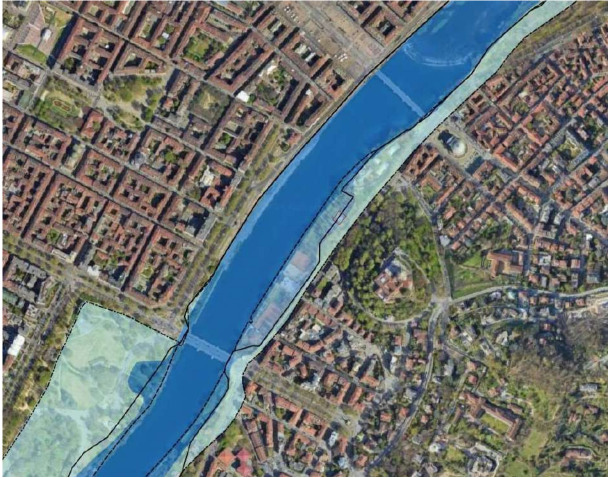
Figura 3 - Fasce di pericolosità idraulica e Fasce fluviali: dettaglio nel tratto più prossimo alle opere in progetto.
