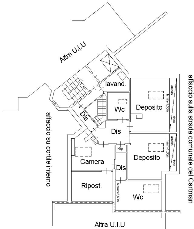
PIANTA PIANO INTERRATO H= 2,50 m
