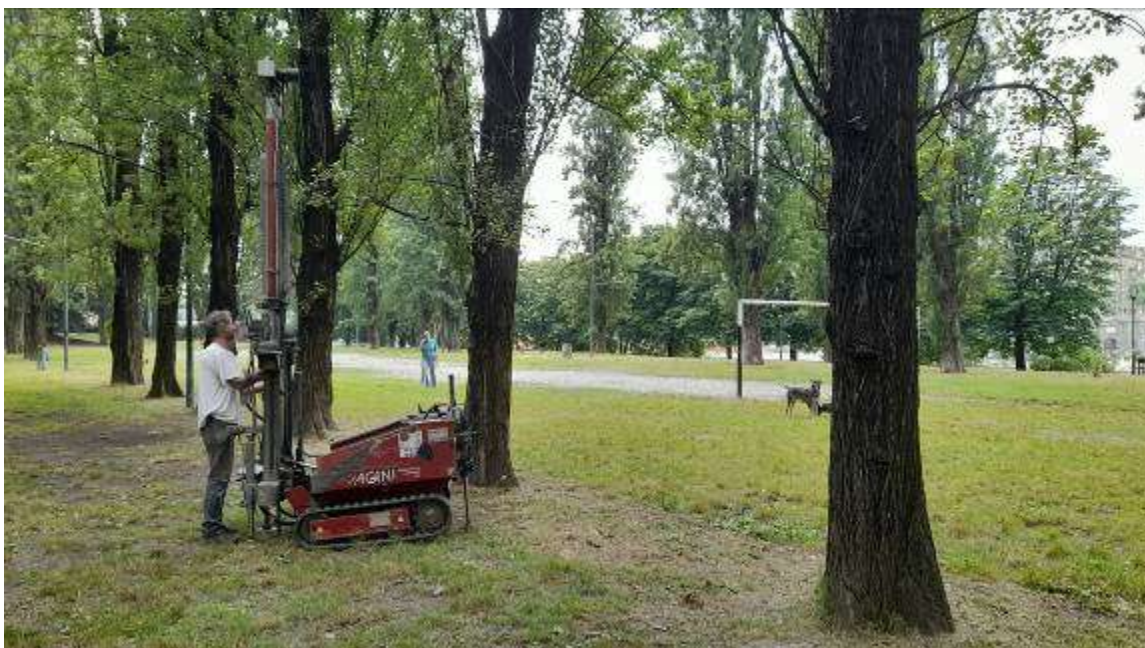
Figura 16 - Esecuzione della prova penetrometrica DIN4
