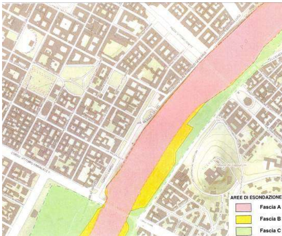
Figura 7 - Individuazione delle fasce fluviali (Fascia A, B e C) all'interno dell'area in esame
