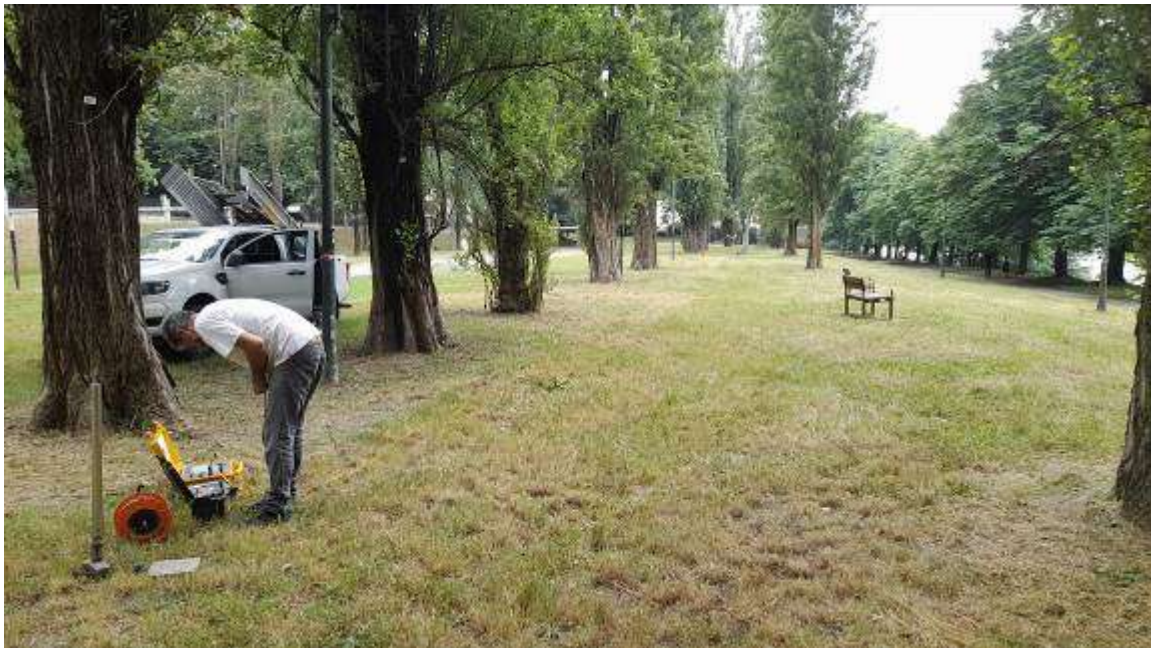
Figura 17 – Esecuzione prova sismica MASW
