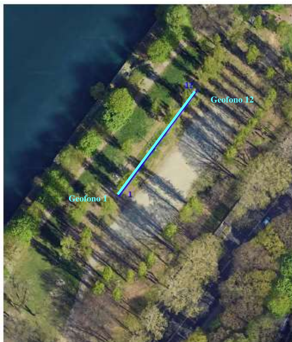
Figura 19 - Ubicazione dello stendimento sismico di tipo MASW Evidenziati l'inizio e la fine della linea di geofoni
