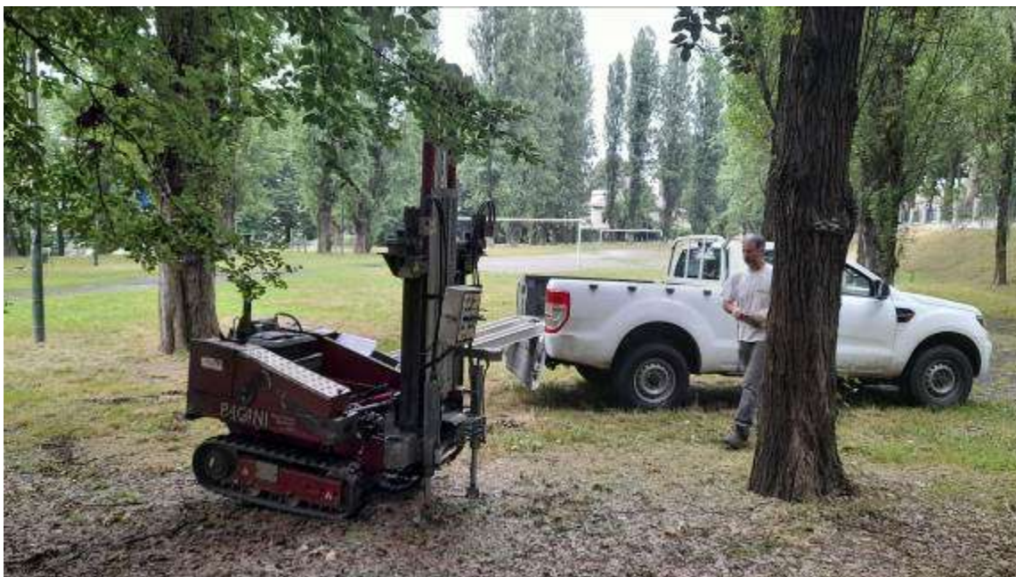
Figura 13 - Esecuzione della prova penetrometrica DIN1
