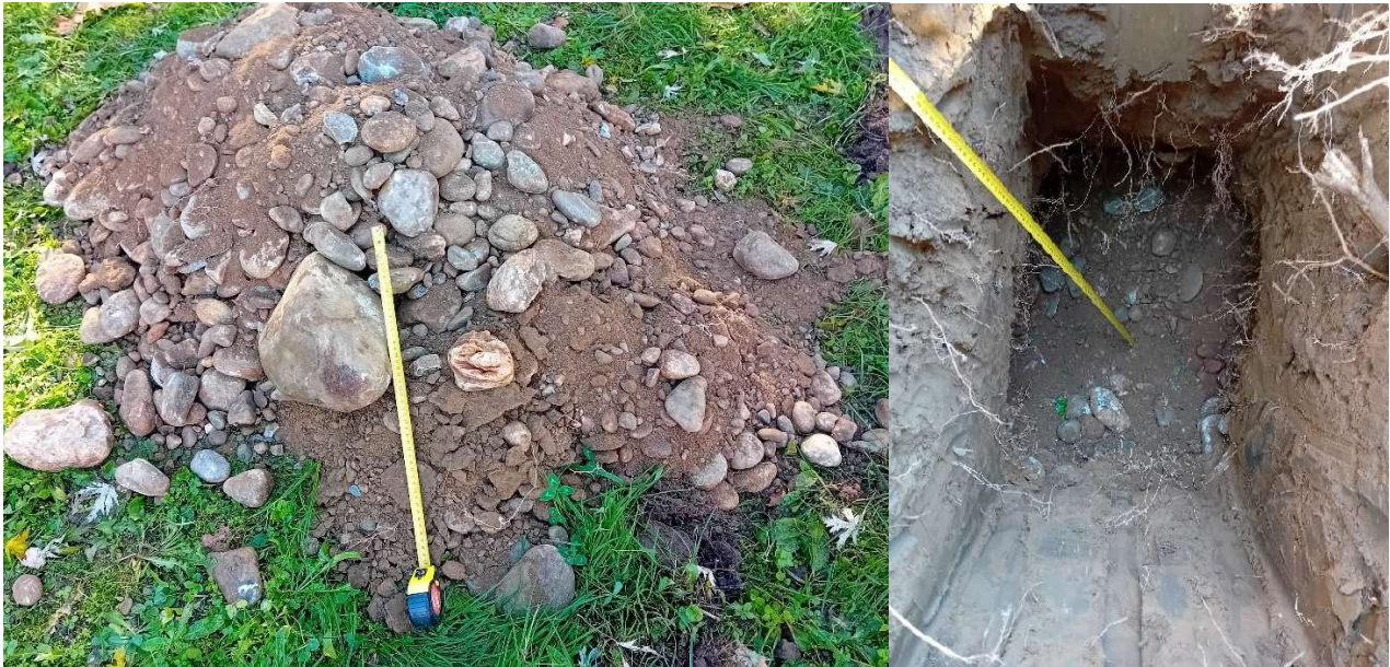
Figura 21 – Terreno di origine fluviale attribuibile all'unità geologica CSN 2b caratterizzato da una granulometria prevalentemente ghiaiosa con presenza di ciottoli, blocchi e matrice sabbioso-limosa (foto a sx) riconducibile all'unità geotecnica U2 rinvenuto nel sondaggio P2 a partire da 1,0 m da p.c. (foto a dx).
