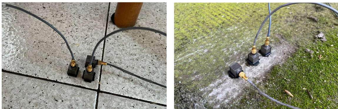
Figura 23. Fotografie relative alle postazioni di misura accelerometrica studiate in appartamento ed alla base dell'edificio
