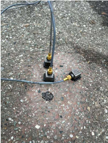
Figura 11. Postazioni accelerometriche alle distanze di 2m e 15m dal binario.
