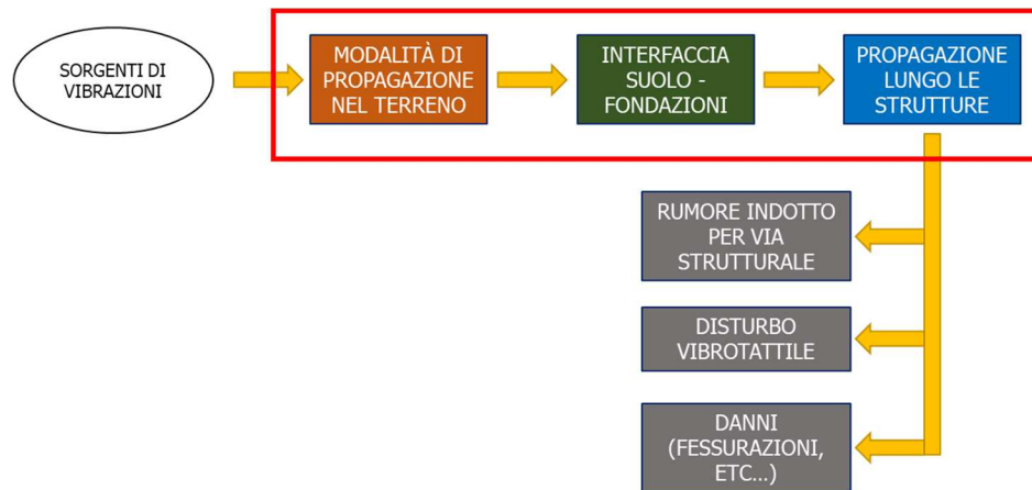
Figura 8. Schema a blocchi di applicazione di un modello previsionale per le vibrazioni.
