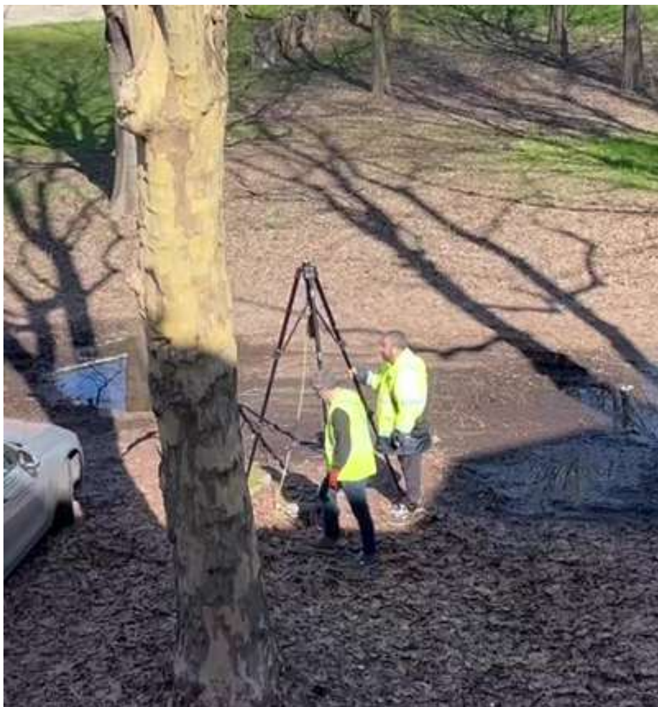
Figura 18. Fotografia scattata all'esterno dell'edificio (punto di impatto per la generazione del segnale impulsivo)
