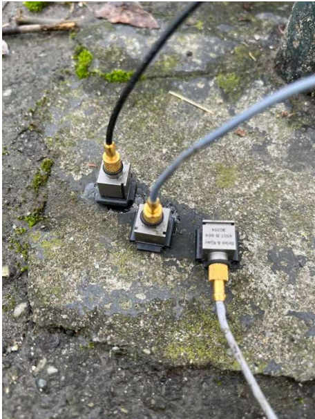
Figura 11. Postazioni accelerometriche alle distanze di 2m e 15m dal binario.
